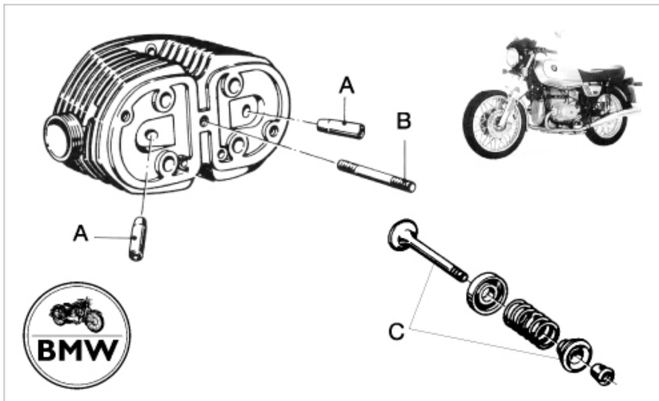
**C:** Selbstverständlich sind Ventile, Federteller, Ventilfehren, Sitzringe und Ventilleile
