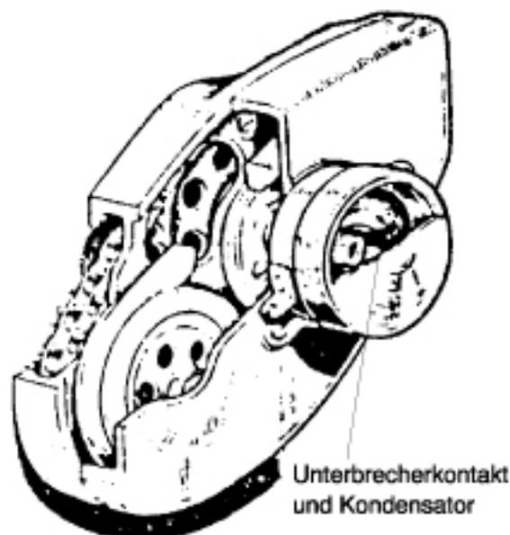
Wir bieten Ihnen eine kontaktlose, elektronische Zündanlage für 6 Volt-BMW-Motorräder R35, die mit wenigen Handgriffen auf Ihrer Motorgehäuse montiert, wahlweise mit neuer oder alter Zündspule, völlig verschleißfrei die Zündarbeit verrichtet! Hierbei **entfallen** die Fehler- und Verschleißquellen von Zündanlagen älterer Bauart wie **Unterbrecher, Kondensator** und **Grundplatte**.
