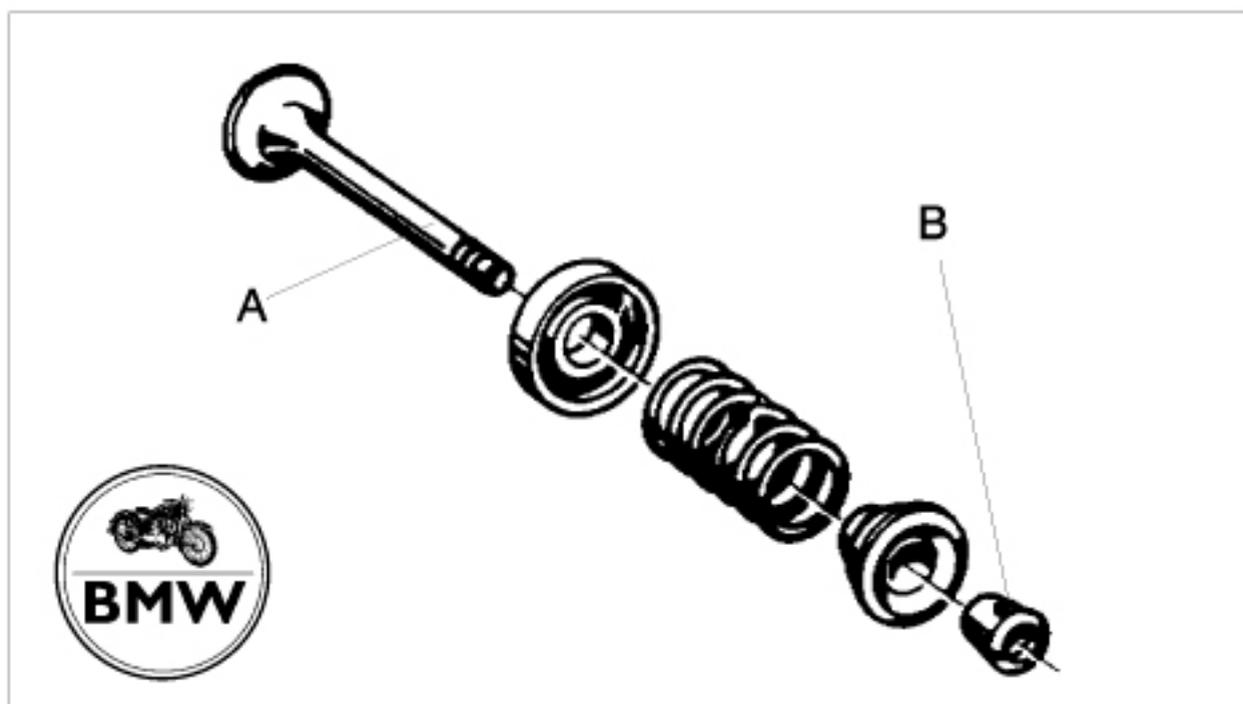
Selbstverständlich sind Ventilführungen, Ventilteller, Ventilsfedern, Sitzringe und Ventilkeile
