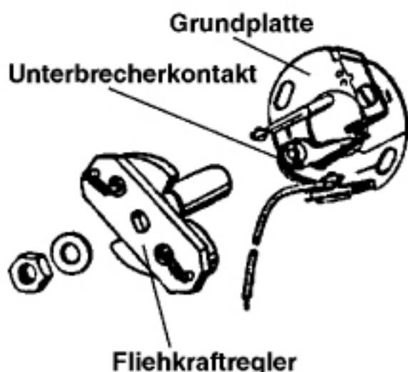
Wir bieten Ihnen eine kontaktlose, elektronische Zündanlage für 12Volt-BMW-Motorräder R50/5-90/S, die mit wenigen Handgriffen auf Ihrer Lichtmaschine montiert, wahlweise mit neuer oder alter Zündspule, völlig verschleißfrei die Zündarbeit verrichtet! Hierbei **entfallen** die Fehler- und Verschleißquellen von Zündanlagen älterer Bauart wie **Unterbrecher, Kondensator, Fliehkraftregler** und **Grundplatte**.
