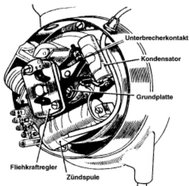
Wir bieten Ihnen eine kontaktlose, elektronische Zündanlage für 6 Volt-BMW-Motorräder R24-R26, die mit wenigen Handgriffen auf Ihrer Lichtmaschine montiert, wahlweise mit neuer oder alter Zündspule, völlig verschleißfrei die Zündarbeit verrichtet! Hierbei **entfallen** die Fehler- und Verschleißquellen von Zündanlagen älterer Bauart wie **Unterbrecher, Kondensator, Fliehkraftregler und Grundplatte**.
